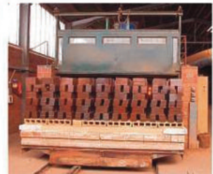
Sieht aus wie ein Schleppkahn, ist aber ein Ziegelofen: Auf einer Breite von 3,50 Metern werden die Ziegel eine Woche lang in dem 100 Meter langen Ofen gebrannt.
